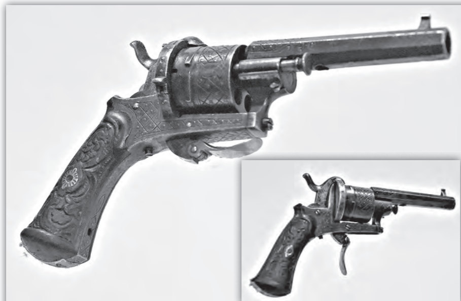
Германский шпильчатый револьвер системы Лефоше, выпущенный не позднее 1909 г.
